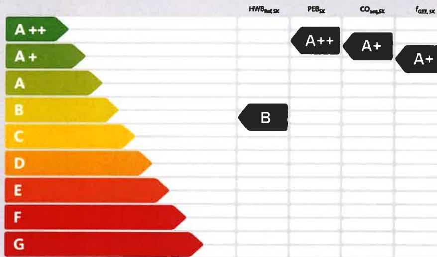
**HWB<sub>ref, SK</sub>**: Der Referenz-Heizwärmebedarf ist jene Wärmemenge, die in den Räumen bereitgestellt werden muss, um diese auf einer normativ geforderten Raumtemperatur, ohne Berücksichtigung allfälliger Erträge aus Wärmerückgewinnung, zu halten.
