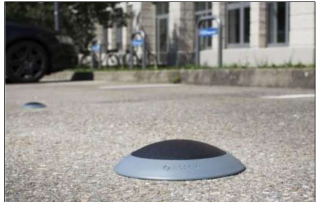
Abbildung 60: Links: P+R-Anlage am Bahnhof und rechts: Beispiel Bodensensor der Firma Bosch (Quelle: BERNARD Gruppe ZT GmbH)
